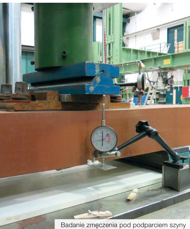
Badanie zmęczenia od drgań
