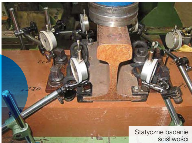
Obciążenie podkładu FFU za pośrednictwem szyny i systemu mocowania szyny do podkładu
