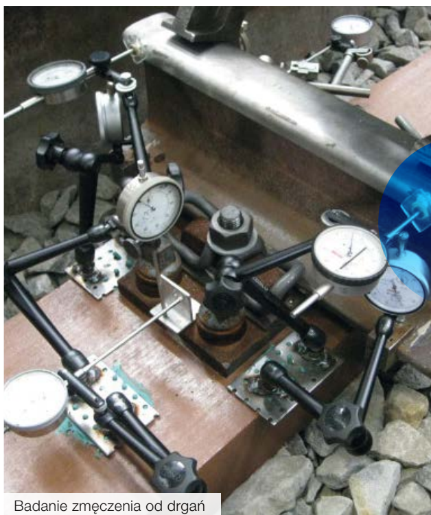
Badanie zmęczenia pod podparciem szyny
